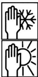
Pigmenty, míchané barevné směsi a ředitlo **T494** Envirobase™ High Performance by měly být skladovány na chladných suchých místech z dosahu zdrojů tepla. Skladovací a přepravní teploty musí udržovány mezi min.+5°C a max.+35°C. Nevystavujte mrazu.
